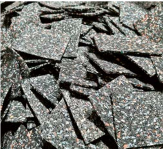
Isopads aus 95 % Altfreifengranulat
