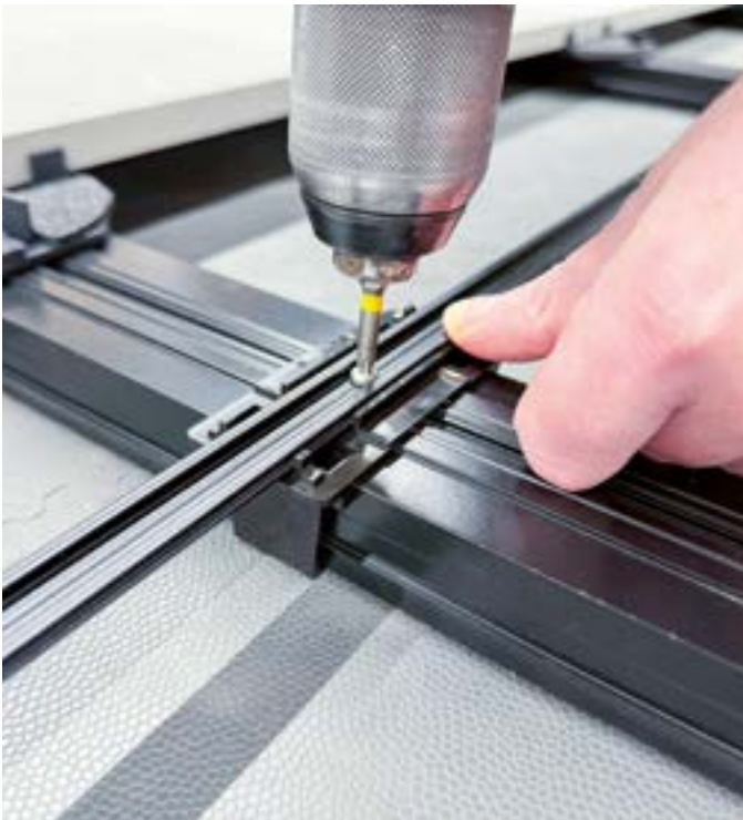
TWIXT-Kreuzverbinder oben (39–76 mm) auf die Unterkonstruktion aufklicken. Kreuzverbinderprofil von oben einsetzen, Konstruktion ausrichten und verschrauben.
